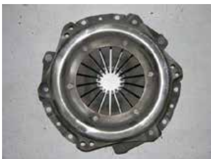
Vue complète de l'embrayage, du carter et du diaphragme ainsi que du disque d'embrayage
