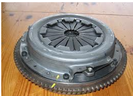
Vue complète de l'embrayage, du carter et du diaphragme ainsi que du disque d'embrayage
