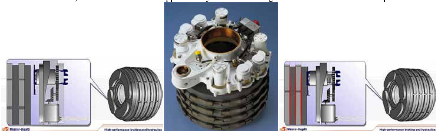
Système de freinage électro-mécanique du Boeing 787 (Messier Bugatti)
