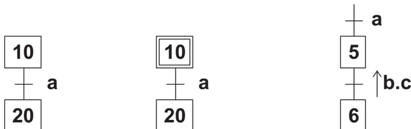
FIG. 4.35 – Exemple d'étapes sources et d'étape puit
