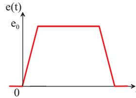
FIG. 6.10 – Entrée en trapèze
