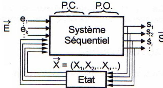
FIG. 3.2 – Schéma général d'un système séquentiel
