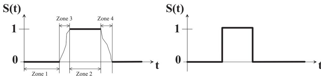
FIG. 1.7 – Signal TOR réel et modèle employé
