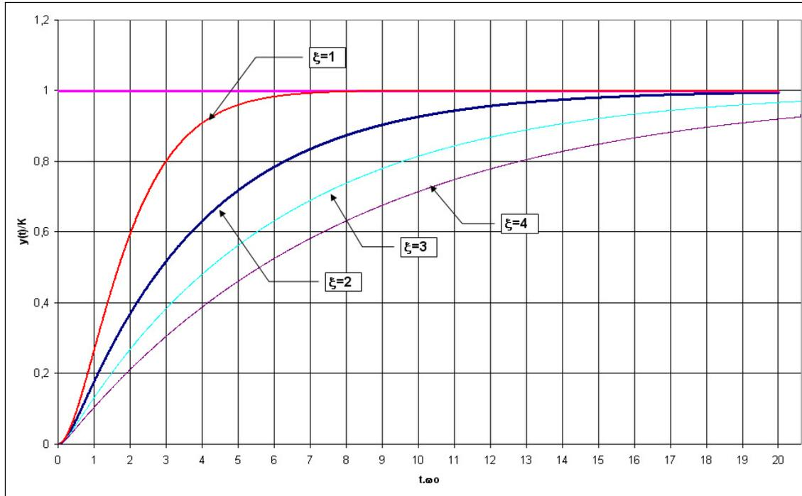
FIG. 7.7 – Réponse indicielle d'un système du second ordre avec  $\xi \geq 1$
