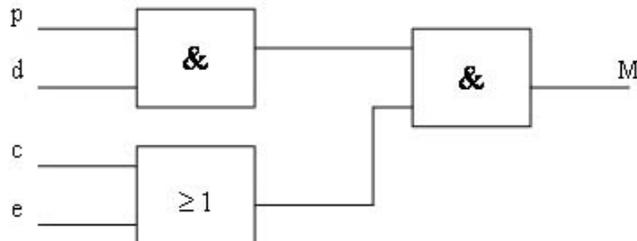
FIG. 2.10 – Logigramme de la fonction de commande de la machine  $M$
