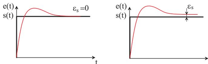
FIG. 5.9 – Système avec et sans écart statique de position (plus ou moins précis)
