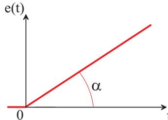
FIG. 6.9 – Entrée de type rampe
