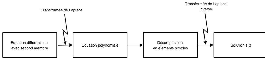
FIG. 6.17 – Principe de résolution par la transformée de Laplace d’une équation différentielle
