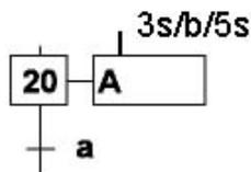
FIG. 4.21 – Exemple d'action retardées et limitée dans le temps
