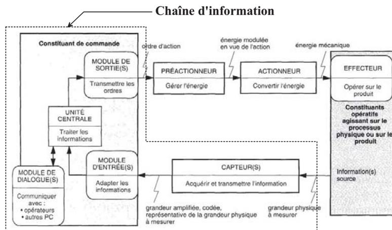
FIG. 1.5 – Diagramme fonctionnel d'un processus automatisé
