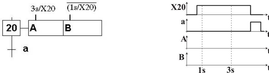
FIG. 4.20 – Exemple d'action retardée dans le temps et action limitée dans le temps
