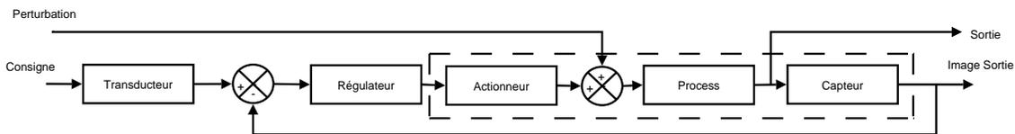
FIG. 6.20 – Boucle d'asservissement “point de vue automaticien”
