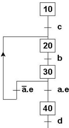
FIG. 4.31 – Exemple de reprise de séquence
