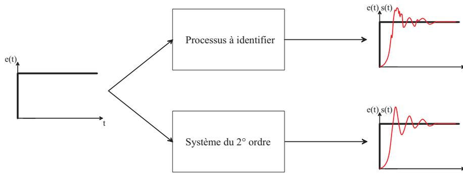
FIG. 6.14 – Détermination d’un modèle de comportement
