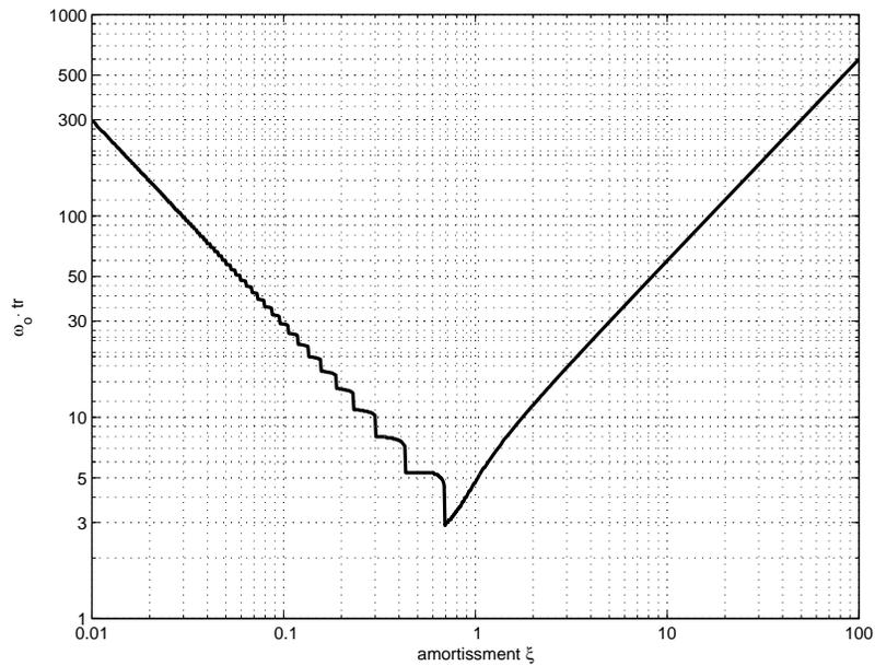
FIG. 7.13 – Temps de réponse réduit d'un système du second ordre
