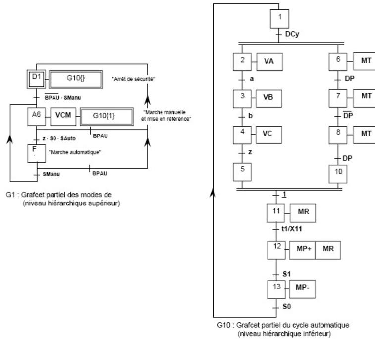
FIG. 4.42 – Grafset du système de dosage avec forçage
