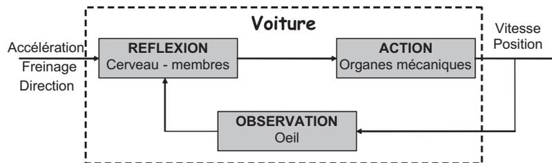
FIG. 1.1 – Principe de la conduite d'un véhicule automobile
