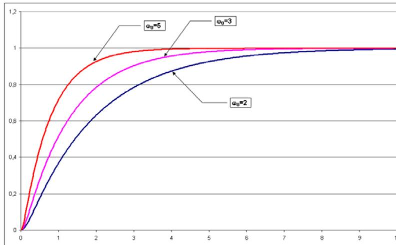
FIG. 7.12 – Évolution de la réponse d'un système non oscillant du second ordre en fonction de  $\omega_0$
