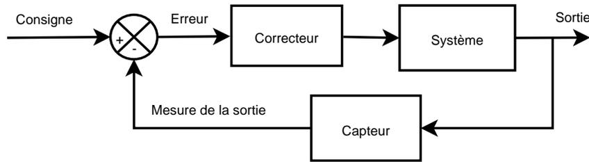
FIG. 5.14 – Schéma d'un système avec correcteur en série
