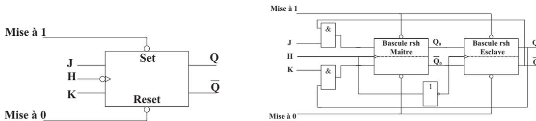
FIG. 3.18 – Symbole et schéma de principe des bascules JK
