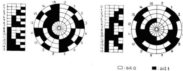
FIG. 2.4 – Codeurs “binaire naturel” et Codeurs “binaire réfléchi”
