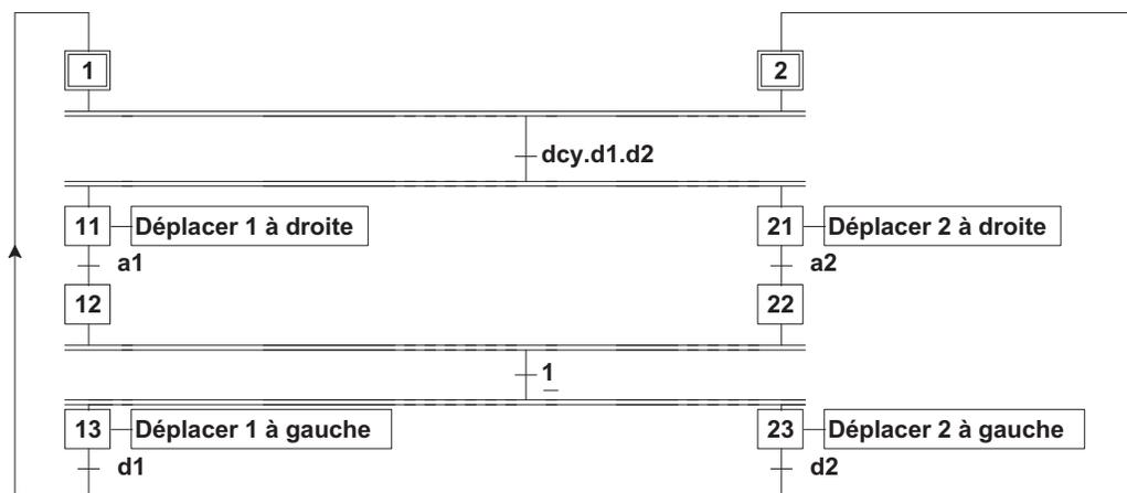
FIG. 4.8 – Exemple de parallélisme structural
