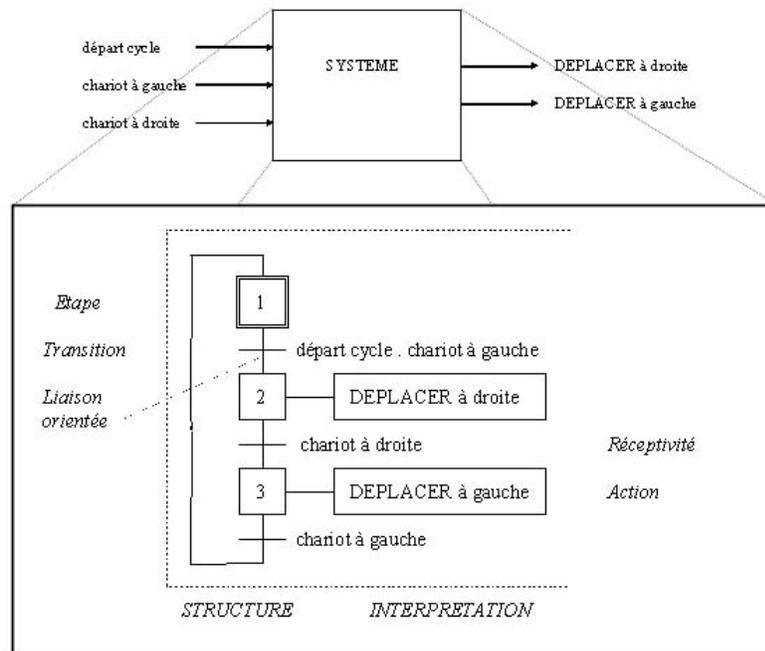
FIG. 4.2 – Principe du GRAFCET
