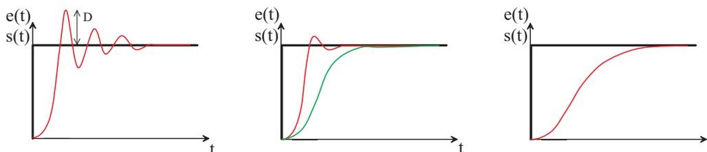
FIG. 5.13 – Système mal amorti, bien amorti (avec ou sans dépassement) et trop amorti
