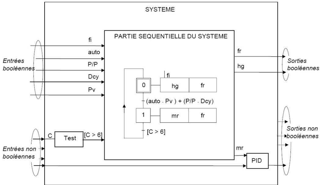
FIG. 4.1 – Situation du grafcet dans un système séquentiel
