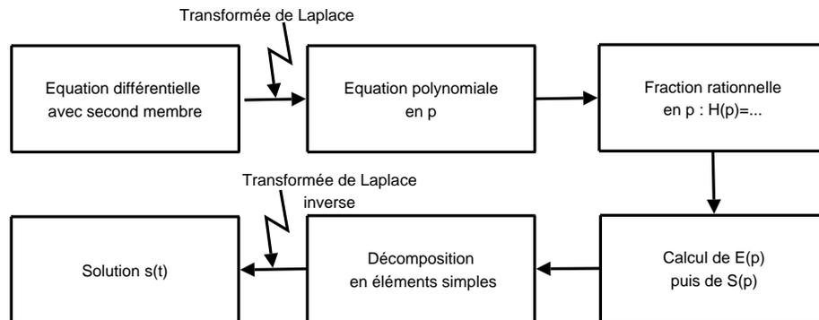
FIG. 6.18 – Principe de résolution d'une équation différentielle
