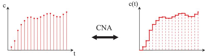
FIG. 6.6 – Principe du convertisseur numérique analogique
