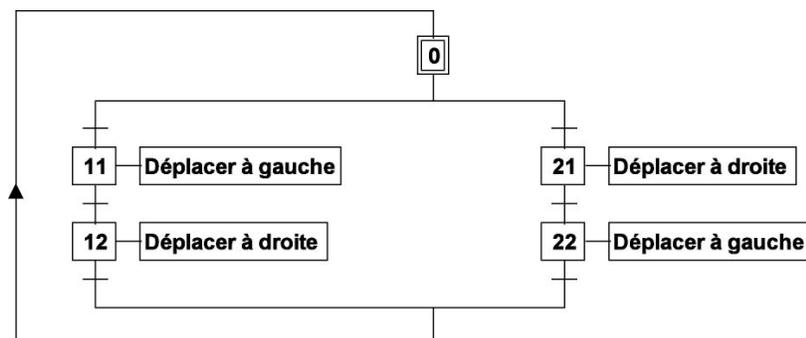
FIG. 4.7 – Exemple de structure avec sélection de séquence
