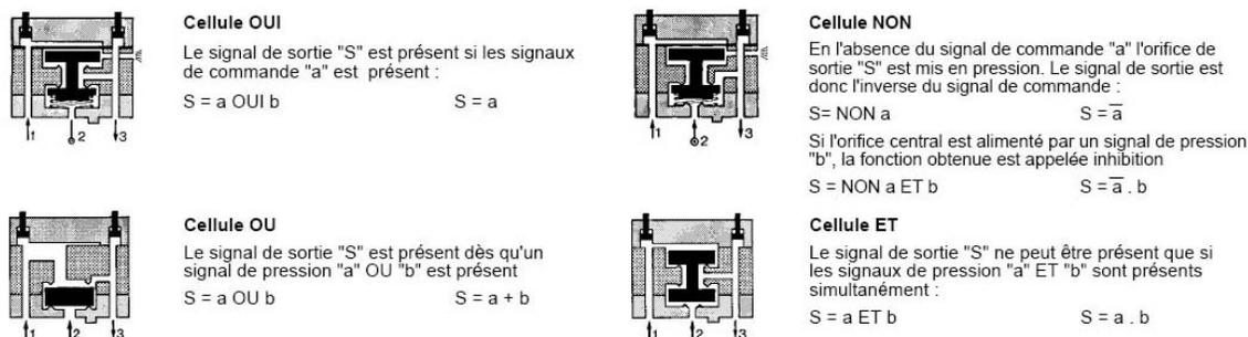
FIG. 2.5 – Principe de fonctionnement des cellules pneumatiques
