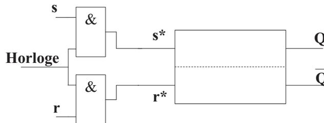
FIG. 3.14 – Principe de la bascule RS synchronisée
