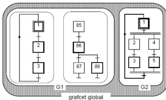
FIG. 4.40 – Exemple de partitionnement d'un grafcet
