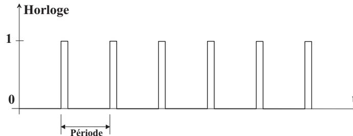
FIG. 3.13 – Signal d'horloge
