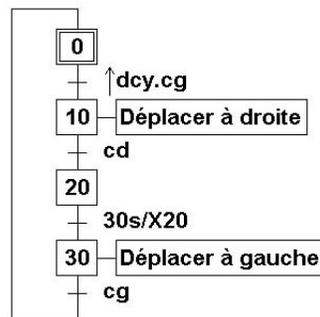
FIG. 4.26 – Exemple de chariot avec temporisation
