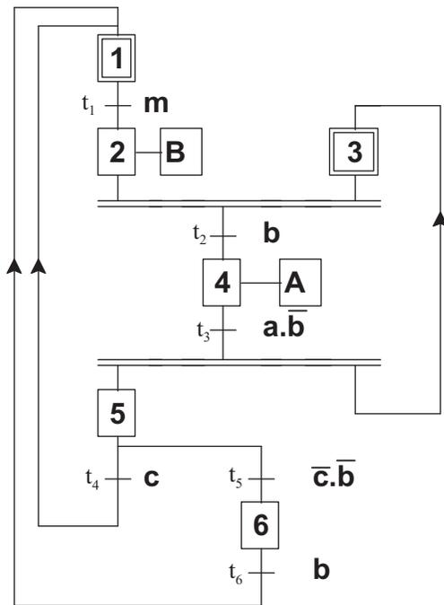
FIG. 4.28 – Grafcet et graphe des situations accessibles
