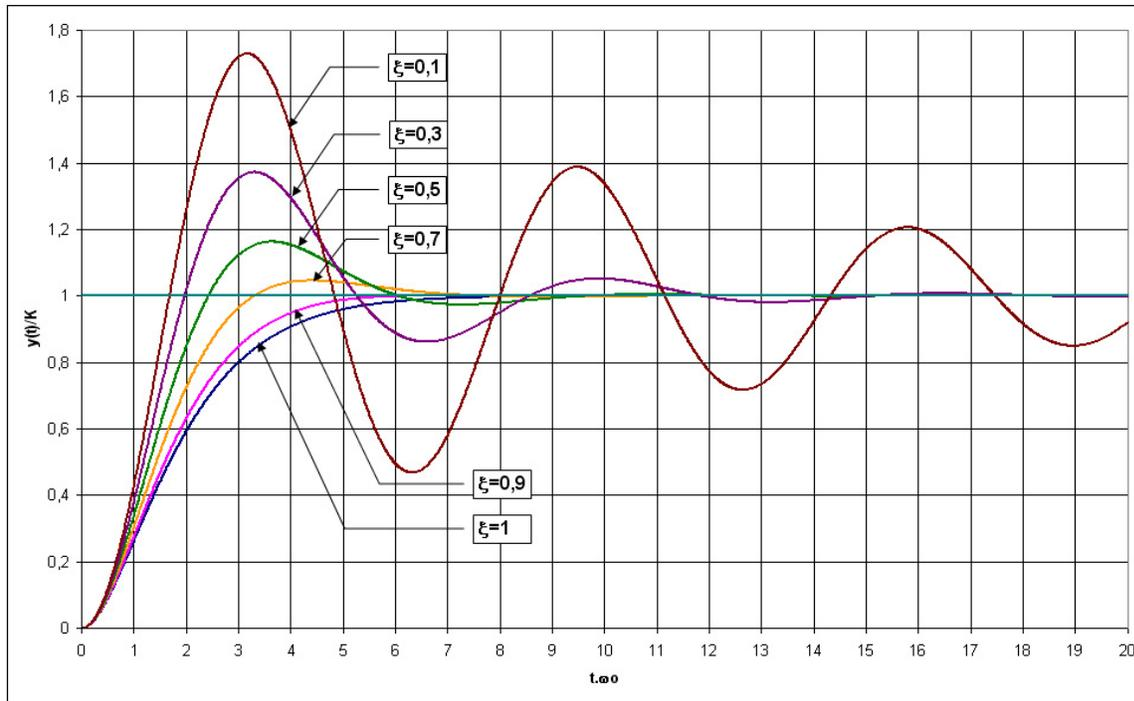
FIG. 7.8 – Réponse indicielle d'un système du second ordre avec  $\xi \geq 1$
