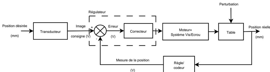
FIG. 5.8 – Schéma de l'asservissement de position
