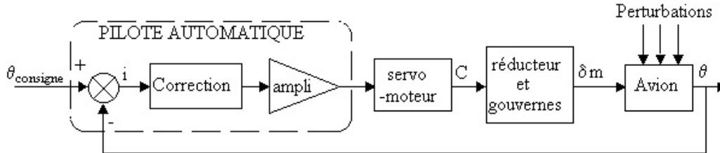
FIG. 6.2 – Schéma de principe d'une partie d'un PA d'avion
