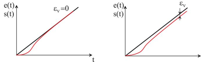
FIG. 5.10 – Système avec et sans écart statique de traînage (plus ou moins précis)
