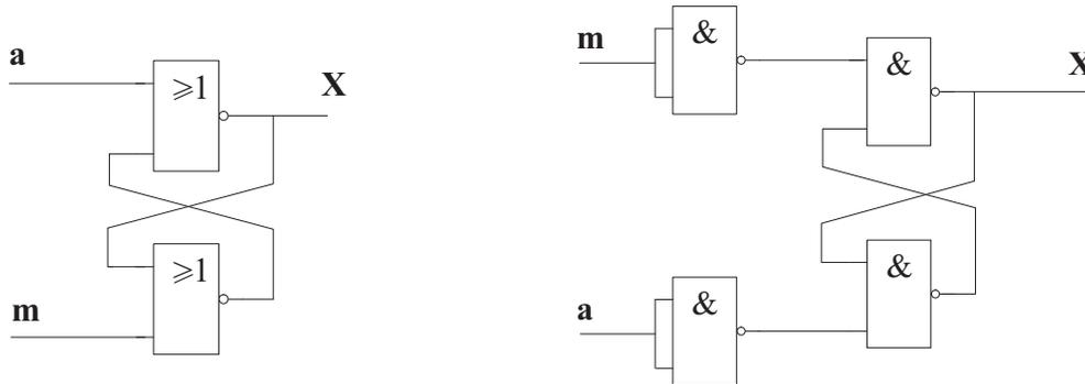
FIG. 3.10 – Schéma logique des mémoires à arrêt et à marche prioritaire
