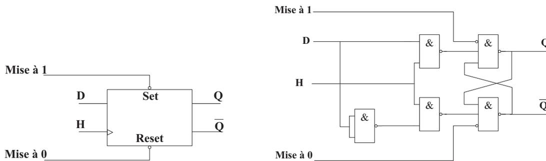
FIG. 3.17 – Symbole et schéma logique des bascules D
