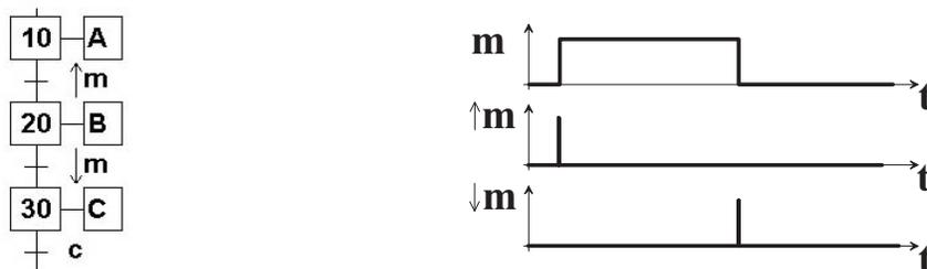
FIG. 4.24 – Front montant et front descendant
