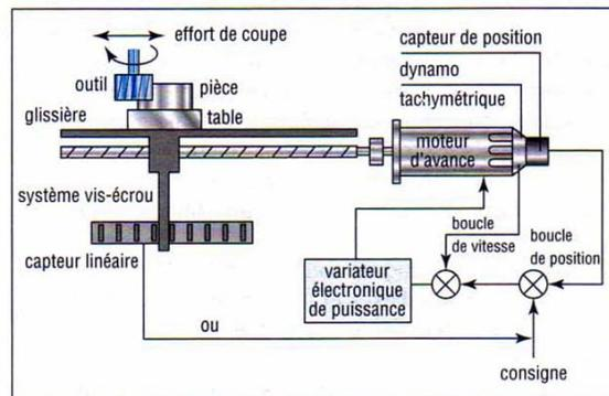
FIG. 5.7 – Principe de la commande d'axe d'une MOCN
