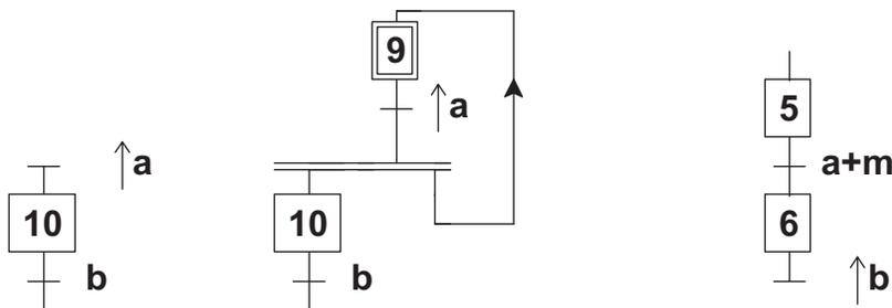
FIG. 4.36 – Exemple de transition source et de transition puit
