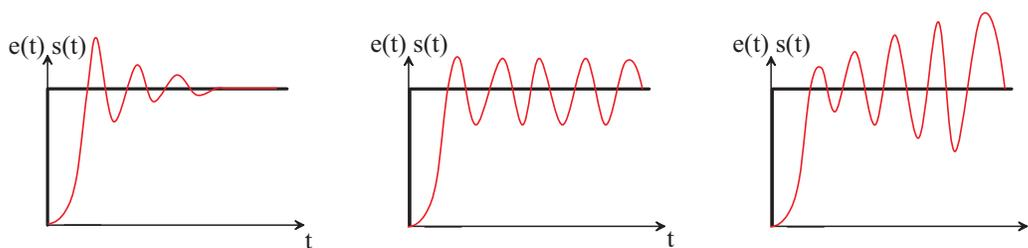
FIG. 5.12 – Système stable, à la limite de la stabilité, instable
