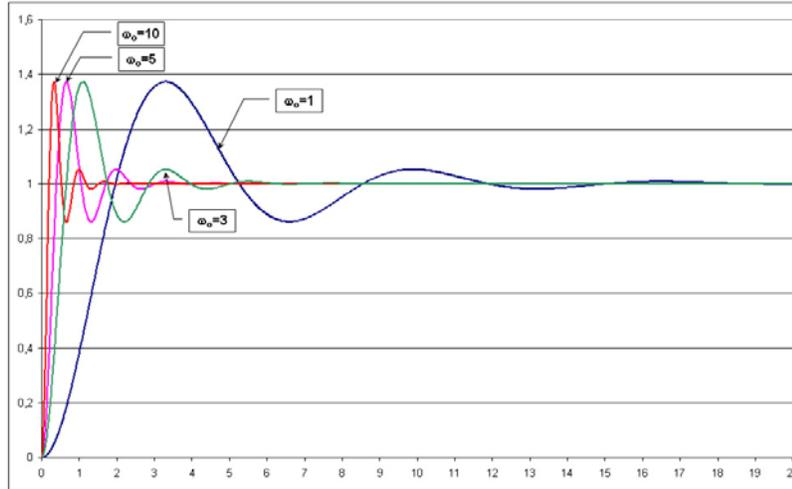
FIG. 7.11 – Évolution de la réponse d'un système pseudo-périodique du second ordre en fonction de  $\omega_0$
