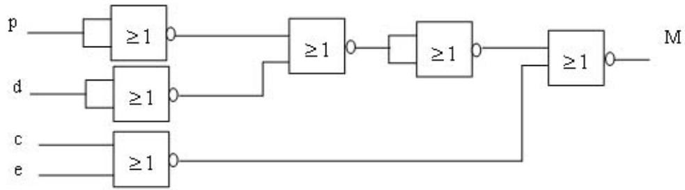
FIG. 2.12 – Schéma logique en NOR de la fonction M
