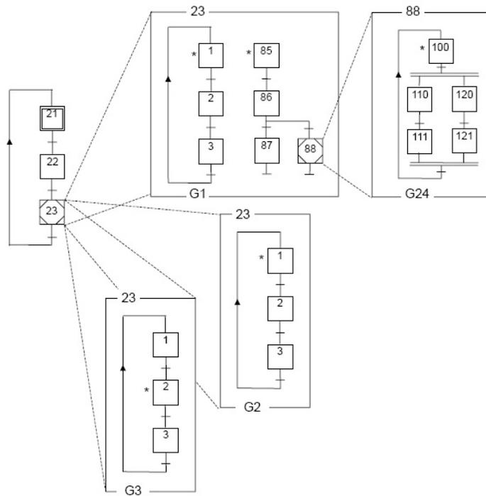
FIG. 4.44 – Exemple d'encapsulation
