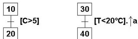
FIG. 4.27 – Exemple de transitions avec prédicat
