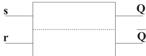
FIG. 3.12 – Schéma normalisé d'une bascule RS
