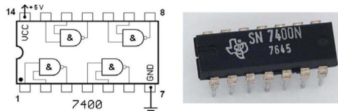
FIG. 2.7 – Porte logique NAND en technologie TTL
