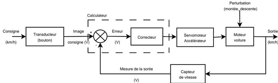
FIG. 5.6 – Principe d'un régulateur de vitesse
