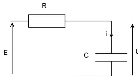
FIG. 6.13 – Exemple de circuit RC
