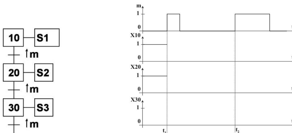
FIG. 4.15 – Exemple d'application de la règle 5
