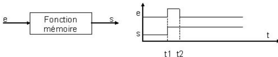
FIG. 3.5 – Principe d'une mémoire
