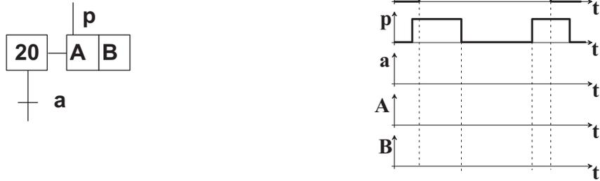
FIG. 4.19 – Exemple d'action conditionnelle
