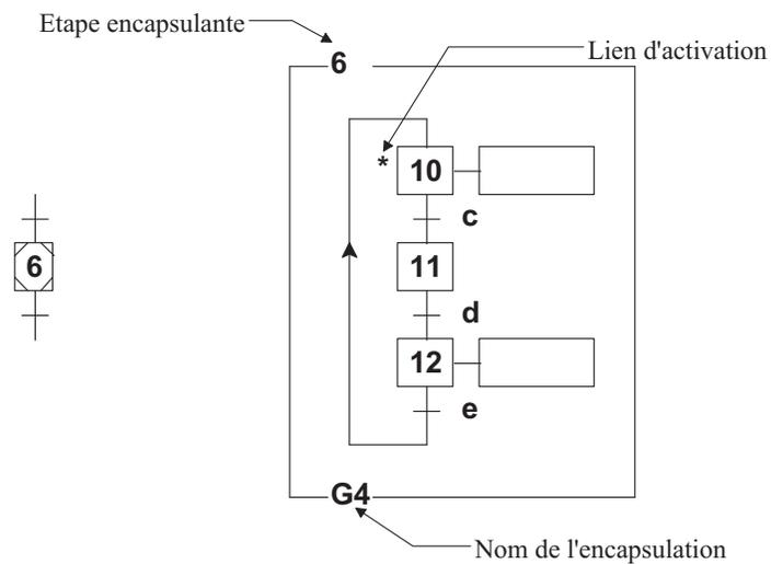
FIG. 4.43 – Exemple d'étape encapsulante et d'encapsulation
