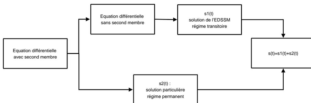
FIG. 6.16 – Principe de résolution classique d'une équation différentielle
