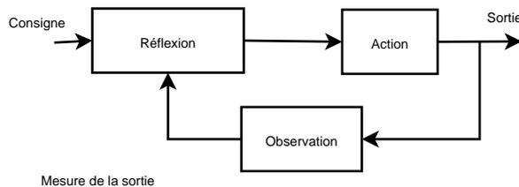
FIG. 5.4 – Principe général d'un asservissement
