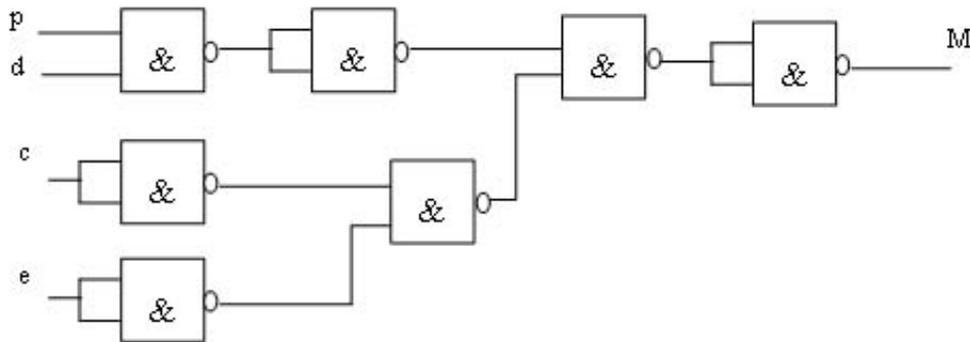
FIG. 2.11 – Schéma logique en NAND de la fonction  $M$
