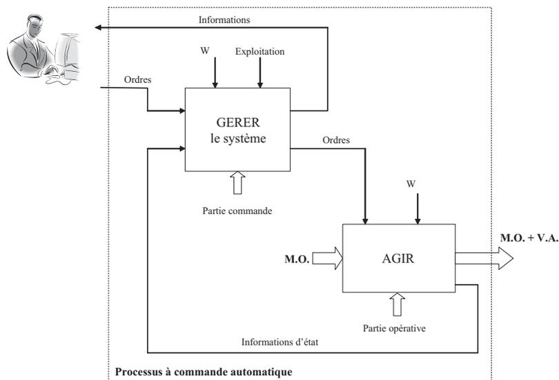
FIG. 1.4 – Diagramme fonctionnel d'un processus automatisé
