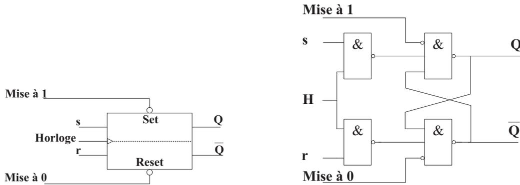
FIG. 3.16 – Symbole et schéma logique des bascules RSH avec forçage
