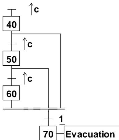
FIG. 4.33 – Exemple d'accumulation
