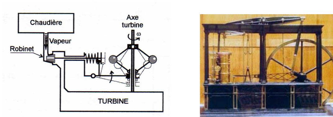
FIG. 1.3 – Machine et régulateur de Watt - principe et réalisation
