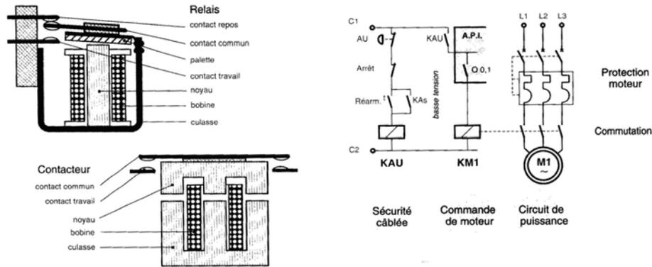
FIG. 3.6 – Relais - Contacteur - Exemple d'utilisation
