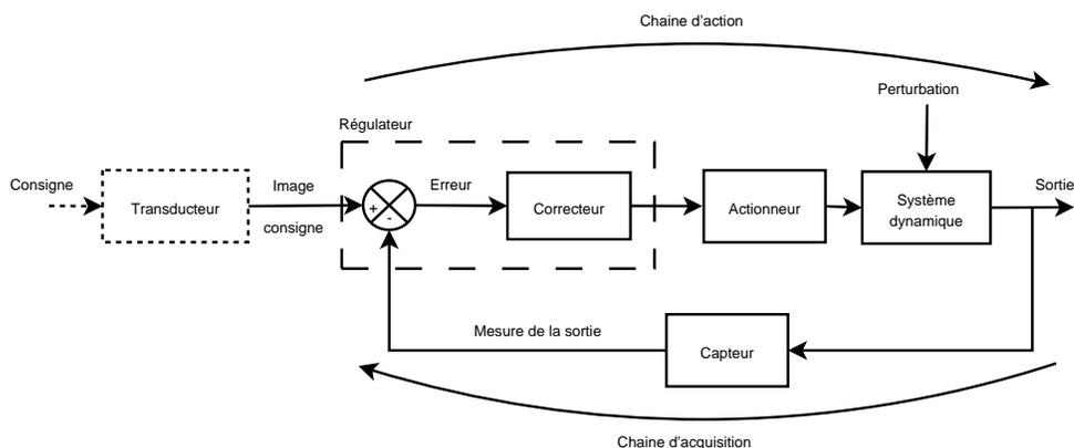
FIG. 5.3 – Représentation d'un système en boucle fermé
