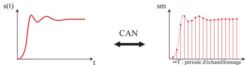
FIG. 6.5 – Principe du convertisseur analogique numérique
