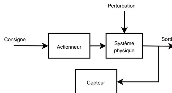
FIG. 5.2 – Représentation d'un système en boucle ouverte
