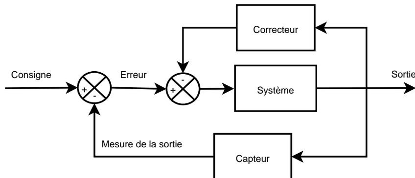
FIG. 5.15 – Schéma d'un système avec correcteur en parallèle
