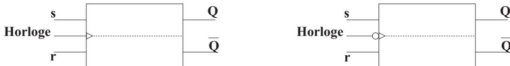
FIG. 3.15 – Symbolisation des bascules RS synchronisées sur front montant ou front descendant
