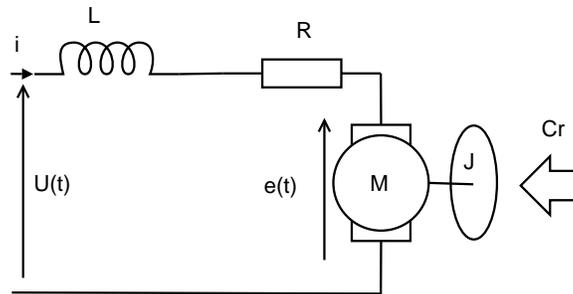
FIG. 6.15 – Modélisation d'un moteur à courant continu
