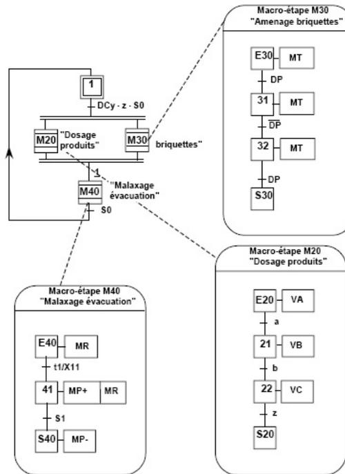
FIG. 4.39 – Description du système par un grafcet avec des macro-étapes
