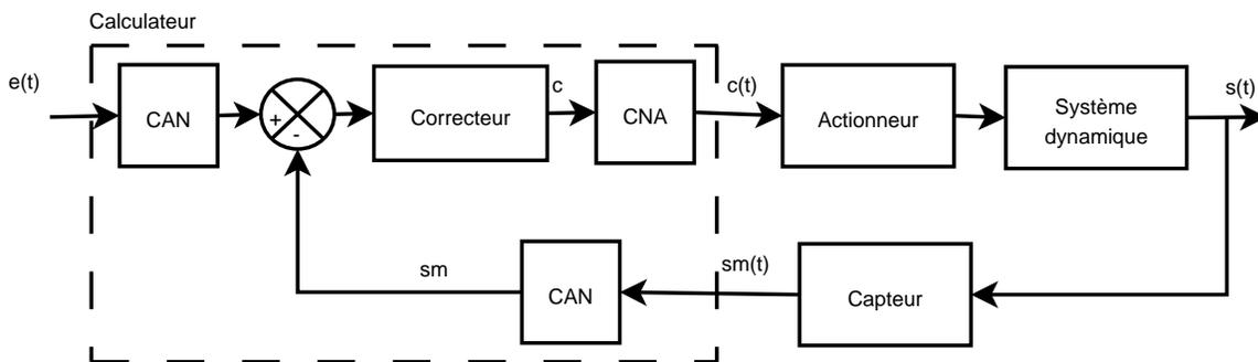
FIG. 6.4 – Exemple de système échantillonné
