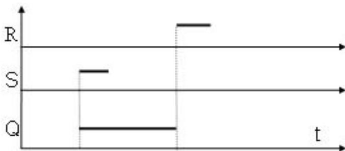
FIG. 3.4 – Diagramme de Gantt d'une bascule RS
