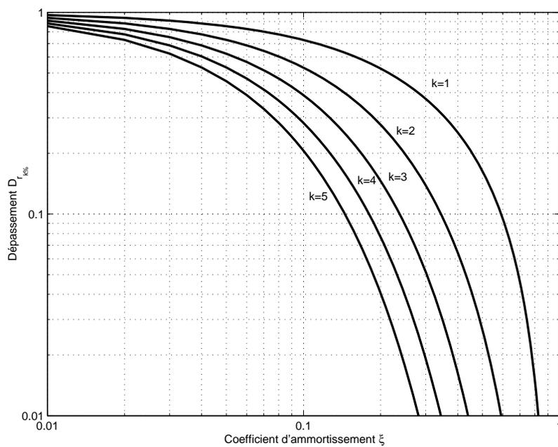
FIG. 7.10 – Dépassements d'un système du second ordre
