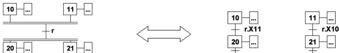
FIG. 4.14 – Structures équivalentes déduites de la règle 4
