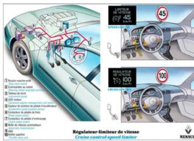
FIG. 5.5 – Éléments constitutifs d'un régulateur-limiteur de vitesse (doc. Renault)
